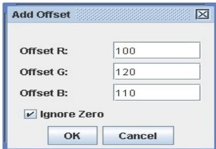
Die eingegebenen Werte werden zum jeweiligen Kanal addiert. Um Werte abzuziehen, geben sie einfach negative Werte ein. Die Funktion vermeidet Werte, die den normalen Wertebereich sprengen würden. Ergäbe sich für ein Pixel beispielsweise ein Wert von 80000, so wird dieser vom System auf 65535 begrenzt. Ergäbe sich ein Wert von -200 so wird dieser auf 0 gesetzt.
